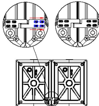
Hinweis: Sollten die Befestigungslöcher der Elemente nicht ausgerichtet sein, lösen Sie die vier M6-Sicherheitschrauben, mit denen das falsch sitzende Element befestigt ist, soweit, dass sich das Element verstellen lässt.
