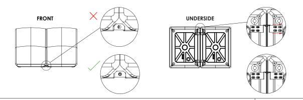
Hinweis: Wenn die Befestigungslöcher an den Verbindungselementen nicht ausgerichtet sind, lösen Sie die 4 x M6-Sicherheitsbolzen, welche das fehljustierte Element an ihrem Platz halten, bis das Element verstellbar wird.
