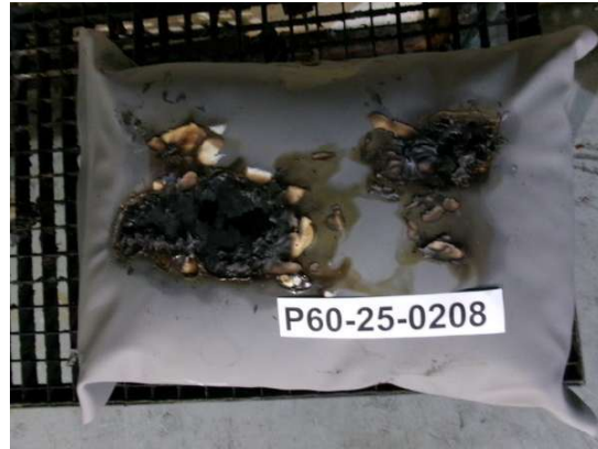
Abb.2: Sitz 1 nach der Prüfung Fig.2: Seat 1 after testing
