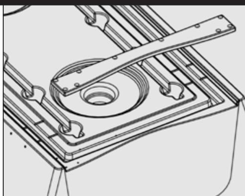
Tragen Sie Dichtungsmasse auf eine Seite des Sockelfüllstücks auf und positionieren Sie es über dem Kopfende des Bettes.
