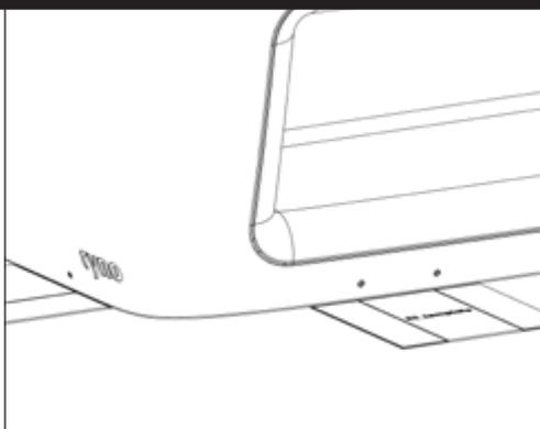
Schablonen unter das Bett schieben und sicherstellen, dass die Führungslinien mit den Führungspunkten übereinstimmen, dann die Führungen mit Klebeband am Boden befestigen.
