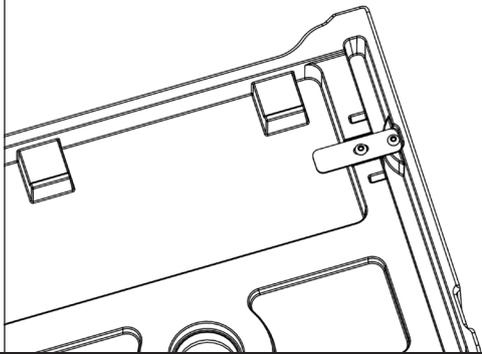
Befestigen Sie die 4 x flachen Platten mit den mitgelieferten M10 Schrauben an die Unterseite des Bettes.
