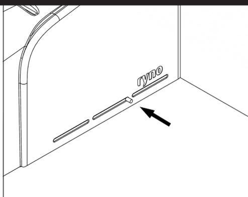
Den Einfüllstutzen einschlagen, um den Zugang zu den Sicherungsschrauben zu blockieren.
