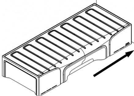
Senken Sie das Bett über die Halterungen und schieben Sie es 40 mm in Längsrichtung, so dass es einrastet.
