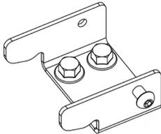
Entfernen Sie die Schablone und schrauben Sie die Halterungen mit den entsprechenden Befestigungselementen am Boden fest.
