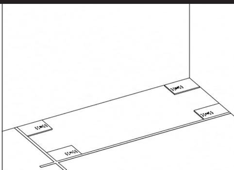
Entfernen Sie das Bett und legen Sie die Befestigungsschablonen an jeder Ecke des markierten Bereichs auf den Boden. Die Schablonen sind wie folgt gekennzeichnet: FL - vorne links, FR - vorne rechts, BL - hinten links, BR - hinten rechts. (An der Vorderseite des Bettes befindet sich eine Aussparung zum Sitzen).
