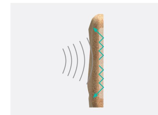
→ **Luftkammern** auf der Rückseite absorbieren Schallwellen und tragen dazu bei, die von der Platte reflektierten Wellen weiter zu reduzieren
