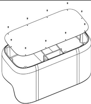
Entfernen Sie alle Sicherungsbolzen und heben Sie die Grundplatte heraus.
