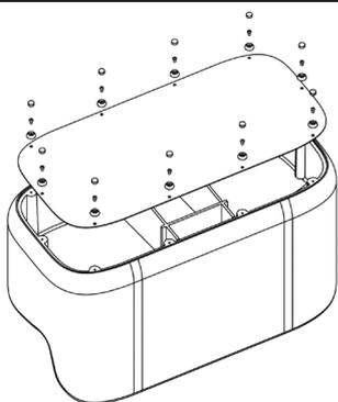
Bringen Sie die Grundplatte wieder an und befestigen Sie die Becher mit den M10 Sicherheitsschrauben. Zum Schluss schlagen Sie die die Kappen ein, um die Füße abzuschließen.
