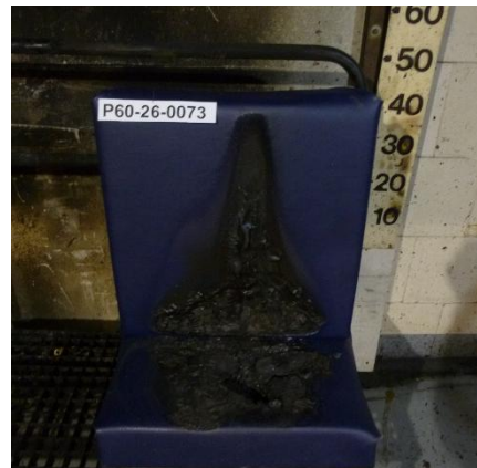
Abb.2: Sitz 1 nach der Prüfung Fig.2: Seat 1 after testing
