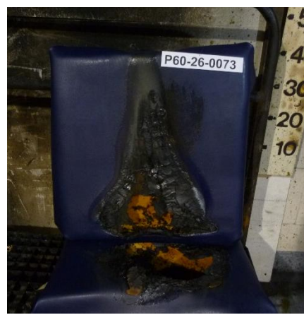
Abb.6: Sitz 3 nach der Prüfung Fig.6: Seat 3 after testing
