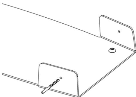
Entfernen Sie die Bank und bohren Sie mit dem kürzeren 4,5-mm-Bohrer durch den Rest der Stahlplatte. (Verwenden Sie Schneidflüssigkeit und den Bohrer mit niedriger Drehzahl)
