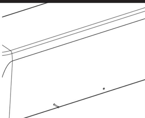
Setzen Sie die mitgelieferten langen Sicherheitsschrauben in jedes der 4 Löcher ein und achten Sie darauf, dass die Köpfe bündig mit der Seite der Bank abschließen.
