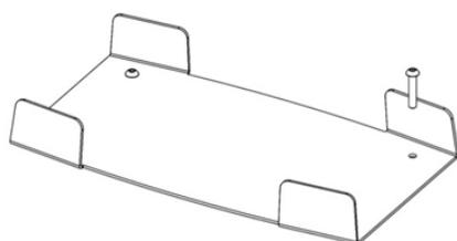
Platzieren Sie eine Halterung auf dem Boden und stellen Sie sicher, dass sie den richtigen Abstand zu den Wänden hat, wie in der Abbildung gezeigt. (90 mm von einer Rückwand und 60 mm von einer Seitenwand). Platzieren Sie die zweite Halterung in dem zuvor in Schritt 1 gemessenen Abstand.
