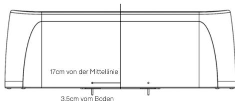
Setzen Sie die Bank auf die Halterungen und bündig zum Boden, wobei die Halterungen mit den Einkerbungen an der Unterseite des Produkts übereinstimmen müssen. Dann bitte zurückschieben, bis die Halterungen in das Produkt einhaken.
