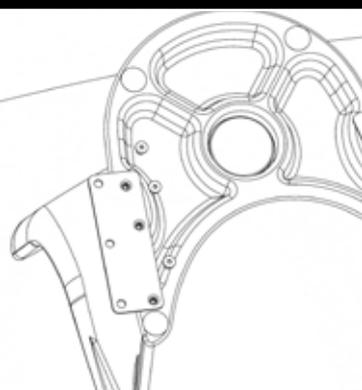
Legen Sie die Montageplatte über die Gewindehülse an der Unterseite des Stuhls, sodass die Löcher mit den Einsätzen übereinstimmen. Schrauben Sie die Schrauben mit der Hand durch die Platte und in das Loch. Dies machen sie mit allen 3 Schrauben.
